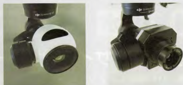
ドローンに搭載されているカメラ 左が可視カメラ(220g)、右が赤外線カメラ(270g)
